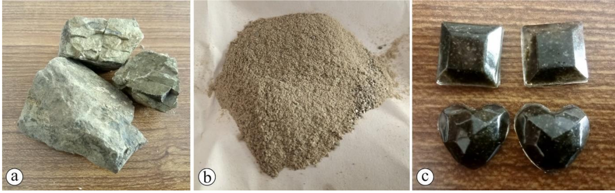
Görsel 2. a) Peridotit kayaç parçaları, b) Öğütülmüş kayaç, c) Üretilen süs taşları.
